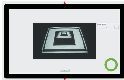
Si la imagen en pantalla no aparece en el centro, se deberá a un fallo de calibrado. Asegúrese de que el módulo PointWrite está correctamente acoplado al proyector.
