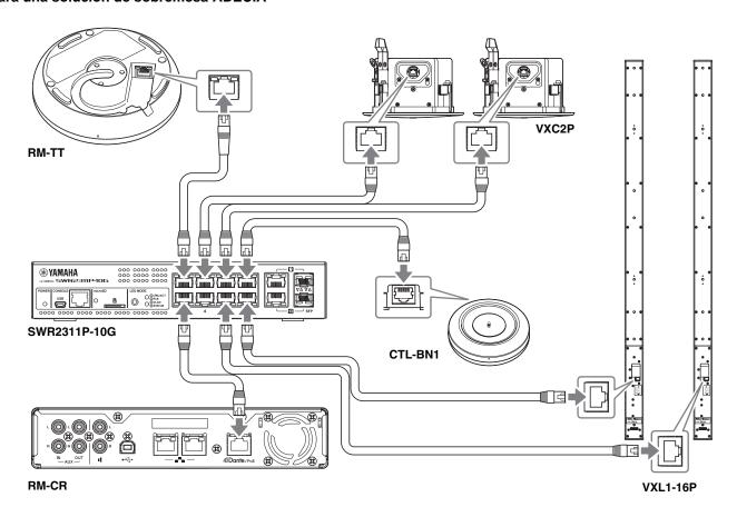
**IMPORTANTE:** Hay interruptores DIP para especificar ajustes en el VXL1-16P y el VXC2P. Antes de conectar los cables LAN, configure los interruptores DIP como se muestra a continuación. La configuración de los interruptores DIP no debe ser la misma en las cuatro unidades.
